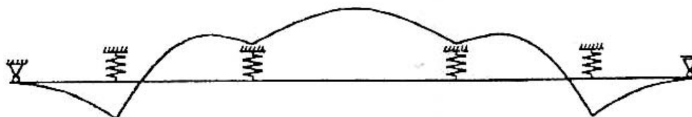
Obr. 6 Výpočetní model pro určení reakcí mostu na pružných podporách od zatížení větrem
